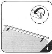
4. Open the snap bar then insert the top edge
